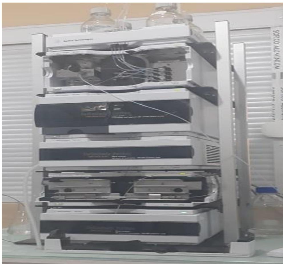
**Figure 12** : l'appareil de HPLC.
